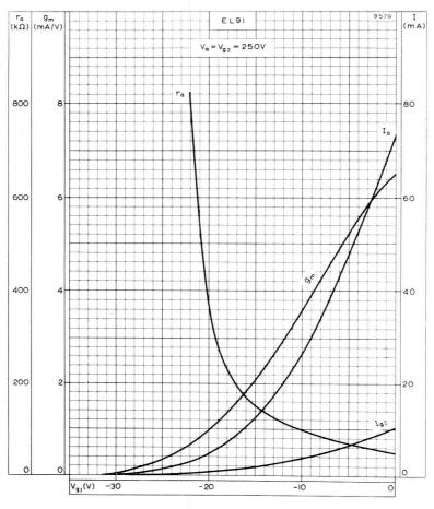
ANODE AND SCREEN-GRID CURRENTS, MUTUAL CONDUCTANCE AND ANODE IMPEDANCE PLOTTED AGAINST CONTROL-GRID VOLTAGE.  $V_{\rm a}=V_{\rm g2}=250 V$
