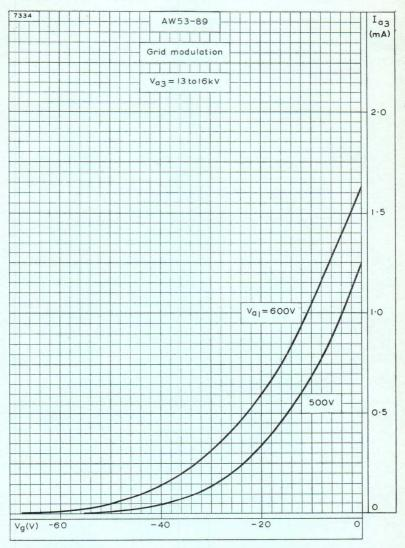
FINAL ANODE CURRENT PLOTTED AGAINST GRID VOLTAGE.
