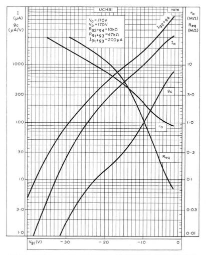
ANODE AND SCREEN-GRID CURRENTS, CONVERSION CONDUCTANCE, ANODE IMPEDANCE AND EQUIVALENT NOISE RESISTANCE PLOTTED AGAINST CONTROL-GRID VOLTAGE WHEN USED AS A FREQUENCY CHANGER.  $V_a=170 \text{V}$
