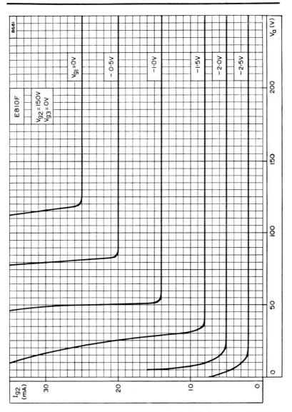
SCREEN-GRID CURRENT PLOTTED AGAINST ANODE VOLTAGE WITH CONTROL-GRID VOLTAGE AS PARAMETER.  $V_{\rm g2}=150 V$
