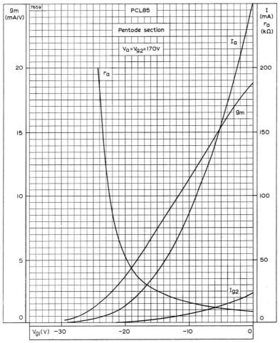
ANODE AND SCREEN-GRID CURRENTS, MUTUAL CONDUCTANCE AND ANODE IMPEDANCE PLOTTED AGAINST CONTROL-GRID VOLTAGE.  $V_{\rm a}=V_{\rm g2}=170V.\ \ \text{PENTODE SECTION}$
