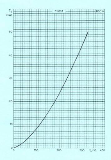
ANODE CURRENT PLOTTED AGAINST ANODE VOLTAGE
