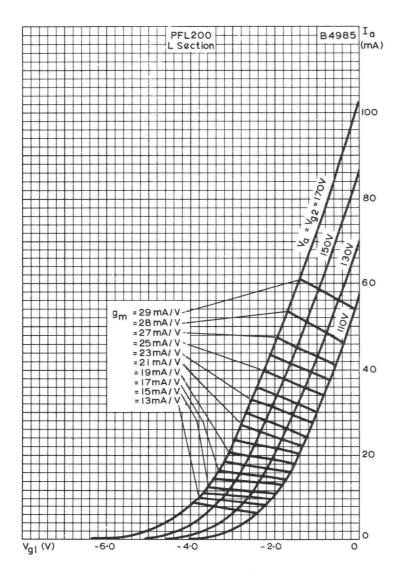
ANODE CURRENT PLOTTED AGAINST CONTROL-GRID VOLTAGE WITH ANODE AND SCREEN-GRID VOLTAGES AS PARAMETERS AND WITH MUTUAL CONDUCTANCE CONTOURS.
