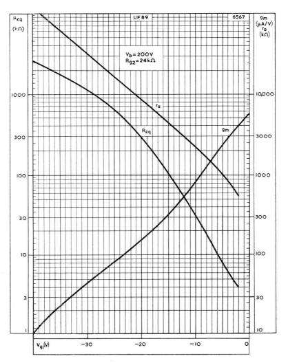
MUTUAL CONDUCTANCE, ANDE IMPEDANCE, AND EQUIVALENT NOISE RESISTANCE PLOTTED AGAINST CONTROL-GRID VOLTAGE  $V_{\rm b}\!=\!200{\rm V}$
