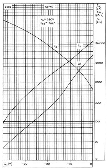
ANODE CURRENT, MUTUAL CONDUCTANCE AND ANODE IMPEDANCE PLOTTED AGAINST CONTROL-GRID VOLTAGE
