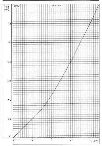
ANODE CURRENT PLOTTED AGAINST ANODE VOLTAGE FOR DIODE SECTION  $a^\prime_{\rm d}$
