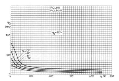
SCREEN GRID CURRENT PLOTTED AGAINST ANODE VOLTAGE WITH CONTROL GRID AS PARAMETER:
