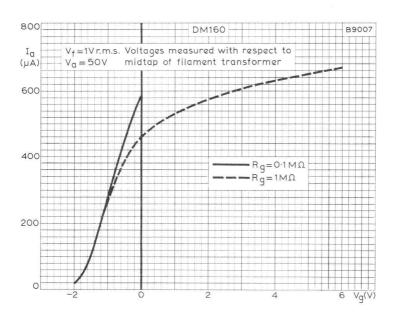
ANODE CURRENT PLOTTED AGAINST GRID VOLTAGE
