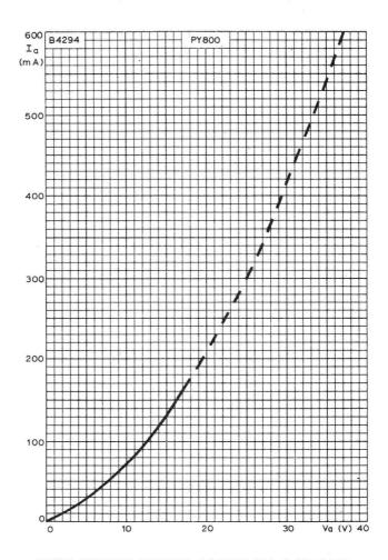
ANODE CURRENT PLOTTED AGAINST ANODE VOLTAGE
