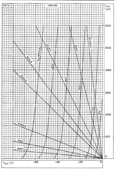
RECTIFIED CURRENT PLOTTED AGAINST OUTPUT VOLTAGE WITH INPUT VOLTAGE BETWEEN 5V\_{\rm r.m.s.} AND 50V\_r.m.s. AS PARAMETER FOR DIODE SECTION  $a^\prime_{\rm d}$
