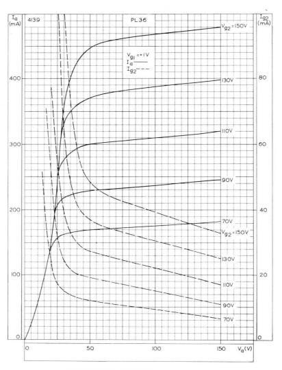
ANODE AND SCREEN-GRID CURRENTS PLOTTED AGAINST ANODE VOLTAGE WITH SCREEN-GRID VOLTAGE AS PARAMETER
