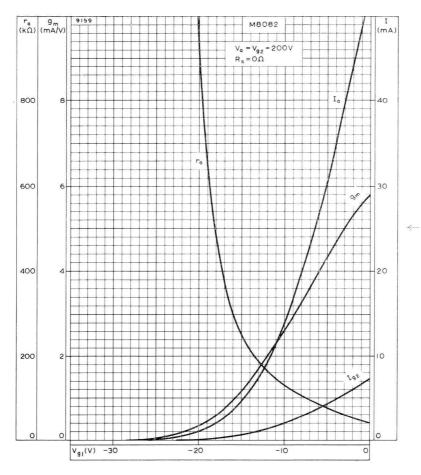
ANODE AND SCREEN-GRID CURRENTS, MUTUAL CONDUCTANCE AND ANODE IMPEDANCE PLOTTED AGAINST CONTROL-GRID VOLTAGE.  $V_a=V_{\rm g2}=200 \text{V}$
