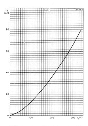
ANODE CURRENT PLOTTED AGAINST ANODE VOLTAGE
