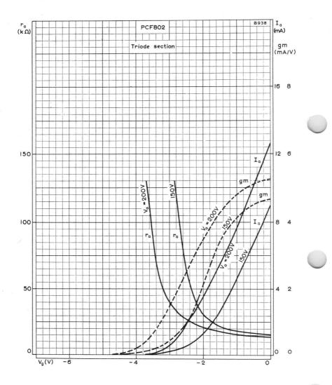
ANODE CURRENT, MUTUAL CONDUCTANCE, AND ANODE IMPEDANCE PLOTTED AGAINST CONTROL-GRID VOLTAGE. TRIODE SECTION
