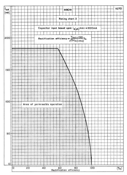
OUTPUT CURRENT PLOTTED AGAINST RECTIFICATION EFFICIENCY
