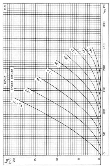
ANODE CURRENT PLOTTED AGAINST ANODE VOLTAGE FOR TRIODE SECTION
