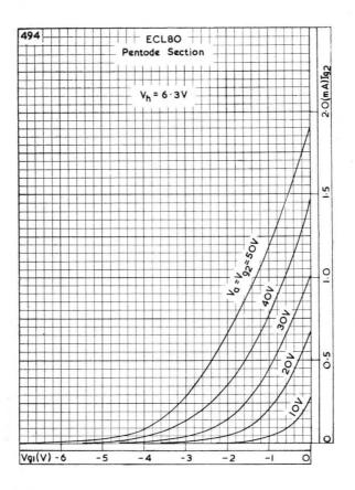
SCREEN-GRID CURRENT OF PENTODE SECTION PLOTTED AGAINST CONTROL-GRID VOLTAGE, FOR ANODE AND SCREEN-GRID VOLTAGES BETWEEN 10V AND 50V
