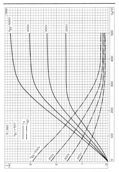
ANODE AND SCREEN-GRID CURRENTS PLOTTED AGAINST ANODE VOLTAGE WITH SCREEN-GRID VOLTAGE AS PARAMETER.  $V_{\rm g1}=+50 \text{V}$
