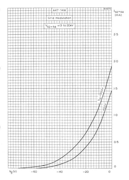
FINAL ANODE CURRENT PLOTTED AGAINST GRID VOLTAGE.
