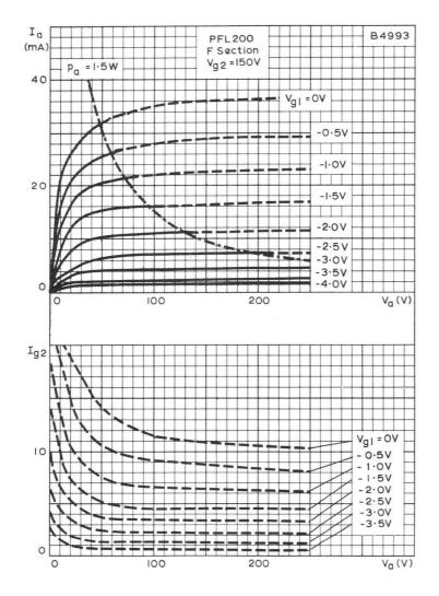
ANODE AND SCREEN-GRID CURRENTS PLOTTED AGAINST ANODE VOLTAGE WITH CONTROL-GRID VOLTAGE AS PARAMETER, V  $_{\rm g2}$  = 150V,  $_{\rm F}$  SECTION
