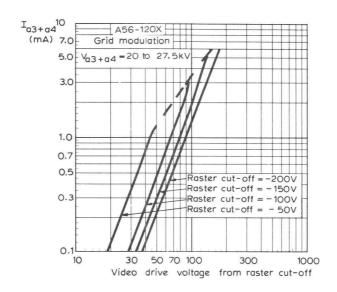
FINAL ANODE CURRENT PLOTTED AGAINST GRID VOLTAGE.
