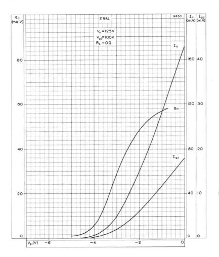
ANODE AND SCREEN-GRID CURRENT AND MUTUAL CONDUCTANCE PLOTTED AGAINST CONTROL-GRID VOLTAGE.  $V_{\rm g2}=100 \text{V}$
