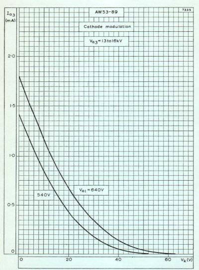
FINAL ANODE CURRENT PLOTTED AGAINST CATHODE-TO-GRID VOLTAGE.
