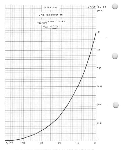
FINAL ANODE CURRENT PLOTTED AGAINST GRID VOLTAGE GRID MODULATION
