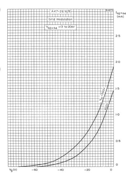
FINAL ANODE CURRENT PLOTTED AGAINST GRID VOLTAGE.
