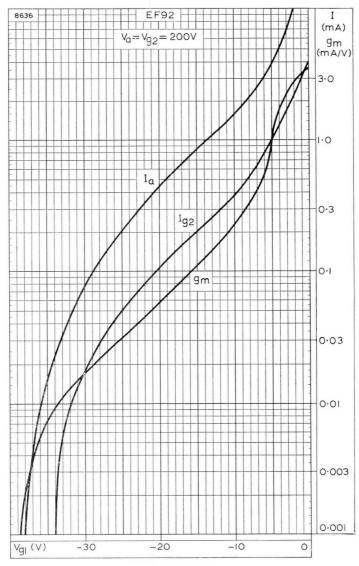
ANODE CURRENT, SCREEN-GRID CURRENT AND MUTUAL CONDUCTANCE PLOTTED AGAINST CONTROL-GRID VOLTAGE.  $V_{\rm a} = V_{\rm g2} = 200 \text{V}$
