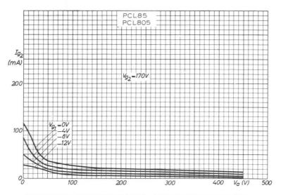
SCREEN GRID CURRENT PLOTTED AGAINST ANODE VOLTAGE
