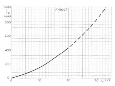
ANODE CURRENT PLOTTED AGAINST ANODE VOLTAGE
