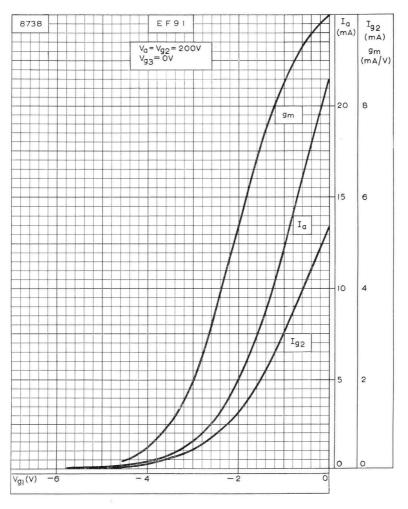
ANODE CURRENT, SCREEN-GRID CURRENT AND MUTUAL CONDUCTANCE PLOTTED AGAINST CONTROL-GRID VOLTAGE.  $V_{\rm a}=V_{\rm g2}=200V$
