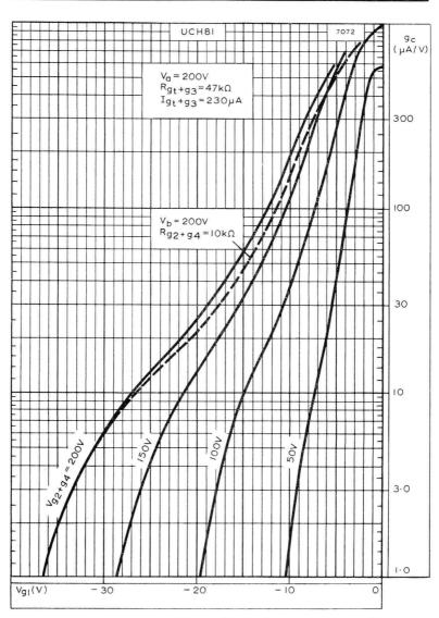
CONVERSION CONDUCTANCE PLOTTED AGAINST CONTROL-GRID VOLTAGE WHEN USED AS A FREQUENCY CHANGER.  $V_{\rm a} = 200 \text{V}$
