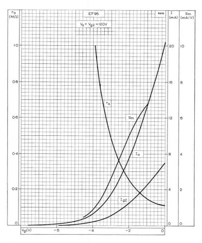
ANODE CURRENT, SCREEN-GRID CURRENT, MUTUAL CONDUCTANCE AND ANODE IMPEDANCE PLOTTED AGAINST CONTROL-GRID VOLTAGE.  $V_{\rm a} = 120 \text{V}$
