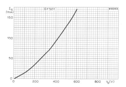
ANODE CURRENT PLOTTED AGAINST ANODE VOLTAGE
