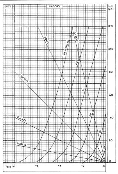
RECTIFIED CURRENT PLOTTED AGAINST OUTPUT VOLTAGE WITH INPUT VOLTAGE BETWEEN 0V AND 5V  $_{\rm r.m.s.}$  AS PARAMETER FOR DIODE SECTION  $a^\prime_{\rm d}$
