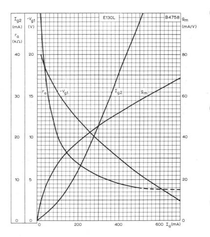
SCREEN CURRENT, CONTROL-GRID VOLTAGE MUTUAL CONDUCTANCE AND ANODE IMPEDANCE PLOTTED AGAINST ANODE CURRENT  $\rm V_a = 250V, \ V_{g2} = 150V$
