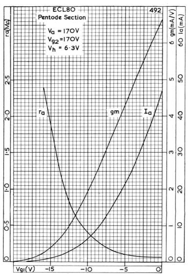
ANODE CURRENT, MUTUAL CONDUCTANCE AND INTERNAL RESIS-TANCE OF PENTODE SECTION PLOTTED AGAINST CONTROL-GRID VOLTAGE FOR SCREEN-GRID VOLTAGE OF 170V
