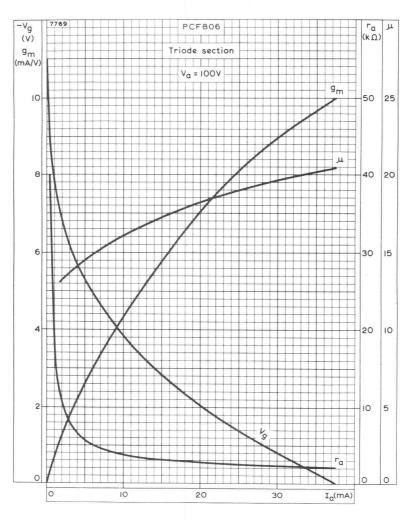
GRID VOLTAGE, MUTUAL CONDUCTANCE, ANODE IMPEDANCE AND AMPLIFICATION FACTOR PLOTTED AGAINST ANODE CURRENT.
