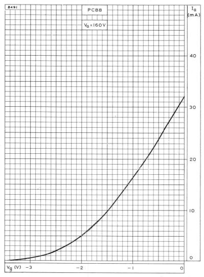
ANODE CURRENT PLOTTED AGAINST GRID VOLTAGE
