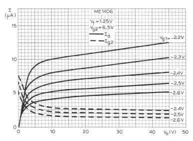
ANODE AND SCREEN-GRID CURRENT PLOTTED AGAINST ANODE VOLTAGE WITH CONTROL-GRID VOLTAGE AS PARAMETER. V  $_{\rm g2}\!=\!6.5{\rm V}$
