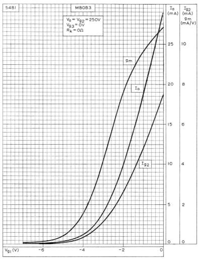
ANODE CURRENT, SCREEN-GRID CURRENT AND MUTUAL CONDUCTANCE PLOTTED AGAINST CONTROL-GRID VOLTAGE.  $V_a=V_{\rm g2}=250V$
