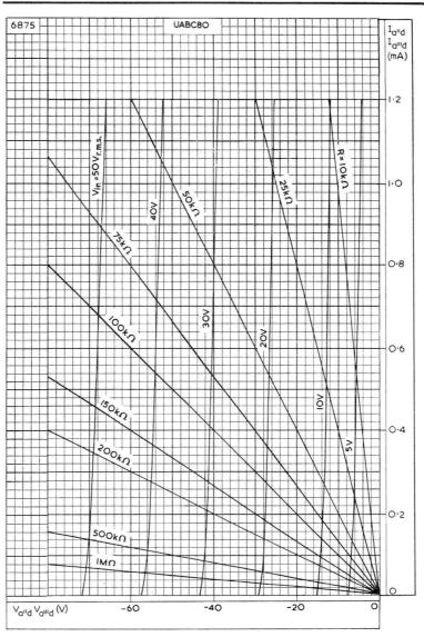
RECTIFIED CURRENT PLOTTED AGAINST OUTPUT VOLTAGE WITH INPUT VOLTAGE BETWEEN 5V\_{\rm r.m.s.} AND 50V\_{\rm r.m.s.} AS PARAMETER FOR DIODE SECTIONS  $a''_{\rm d}$  AND  $a'''_{\rm d}$
