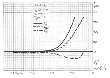
ANODE, SCREEN-GRID AND CONTROL-GRID CURRENTS PLOTTED AGAINST CONTROL-GRID VOLTAGE. V<sub>a</sub> = 10V, V<sub>g2</sub> = 10V
