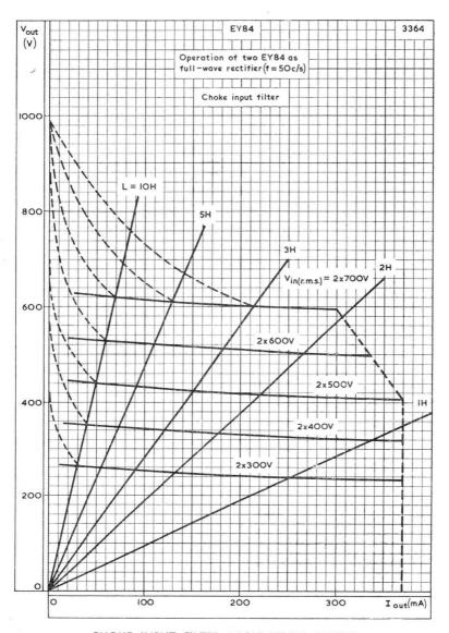
CHOKE INPUT FILTER REGULATION CURVES
