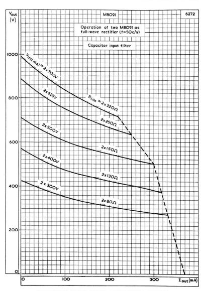
CAPACITOR INPUT FILTER REGULATION CURVES
