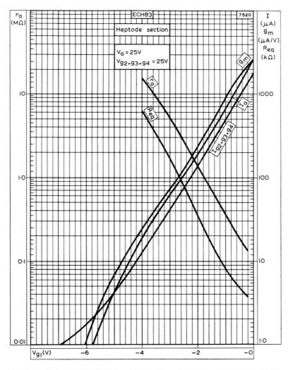
ANODE AND SCREEN-GRID CURRENTS, MUTUAL CONDUCTANCE, ANODE IMPEDANCE AND EQUIVALENT NOISE RESISTANCE PLOTTED AGAINST CONTROL-GRID VOLTAGE FOR HEPTODE SECTION  $V_a = V_{\rm g2+g3+g4} = 25 \text{V}$
