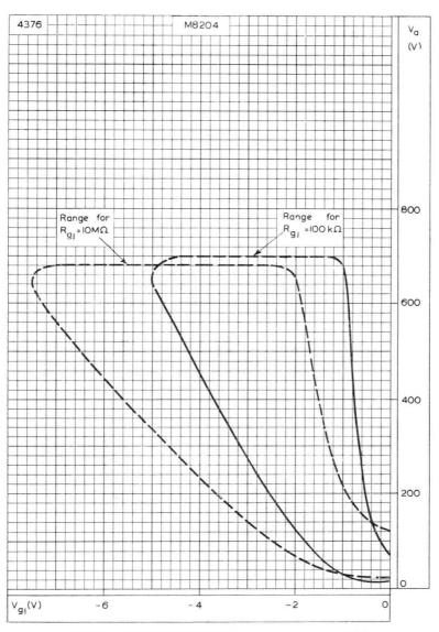
OPERATING RANGE OF CRITICAL GRID VOLTAGE
