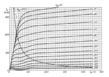
ANODE CURRENT PLOTTED AGAINST ANODE VOLTAGE
