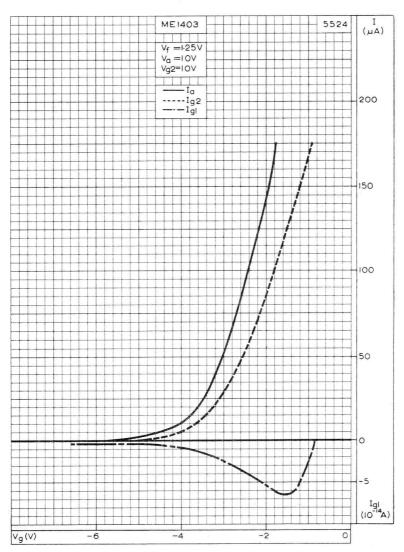
ANODE, SCREEN-GRID AND CONTROL-GRID CURRENTS PLOTTED AGAINST CONTROL-GRID VOLTAGE.  $V_{\rm a}=10V,\ V_{\rm g2}=10V$
