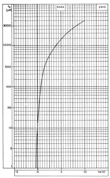
ANODE CURRENT PLOTTED AGAINST ANODE VOLTAGE
