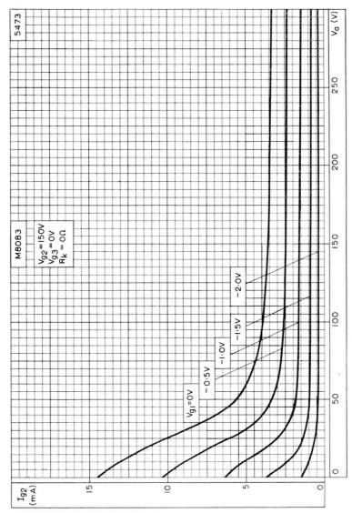
SCREEN-GRID CURRENT PLOTTED AGAINST ANODE VOLTAGE WITH CONTROL-GRID VOLTAGE AS PARAMETER.  $V_{\rm g2}=150 \text{V}$
