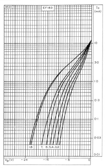
ANODE CURRENT PLOTTED AGAINST CONTROL-GRID VOLTAGE.
