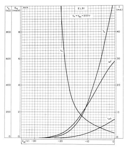
ANODE AND SCREEN-GRID CURRENTS, MUTUAL CONDUCTANCE AND ANODE !MPEDANCE PLOTTED AGAINST CONTROL-GRID VOLTAGE.  $V_{\rm a}{=}V_{\rm g2}{=}200V$
