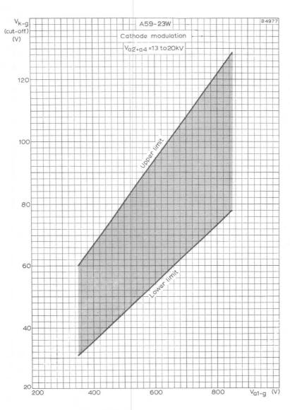
LIMITS OF CATHODE-TO-GRID CUT-OFF VOLTAGE PLOTTED AGAINST FIRST ANODE-TO-GRID VOLTAGE.
