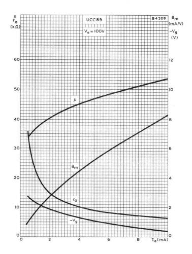
MUTUAL CONDUCTANCE, ANODE IMPEDANCE, AMPLIFICATION FACTOR AND GRID VOLTAGE PLOTTED AGAINST ANODE CURRENT,  $\mathbf{V_a} = 100 \mathrm{V}$
