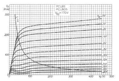
ANODE CURRENT PLOTTED AGAINST ANODE VOLTAGE
