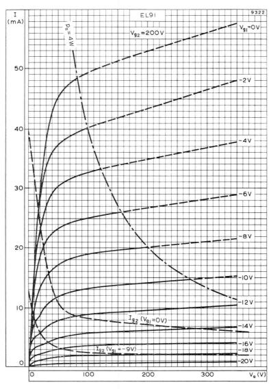
ANODE AND SCREEN-GRID CURRENTS PLOTTED AGAINST ANODE VOLTAGE WITH CONTROL-GRID VOLTAGE AS PARAMETER.  $V_{\rm g2}=200V$
