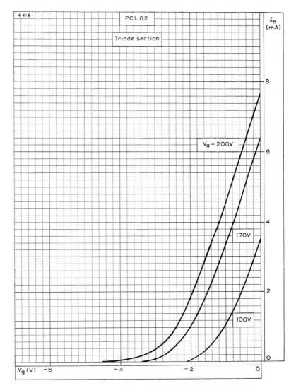
ANODE CURRENT PLOTTED AGAINST GRID VOLTAGE.
