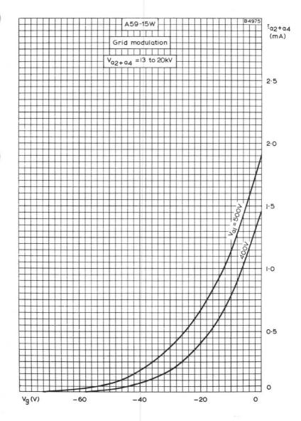
FINAL ANODE CURRENT PLOTTED AGAINST GRID VOLTAGE.
