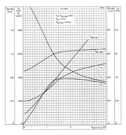
PERFORMANCE CURVES FOR USE AS A FREQUENCY CHANGER  $V_{\rm a} = V_{\rm g2+g4} = 25 \text{V}$
