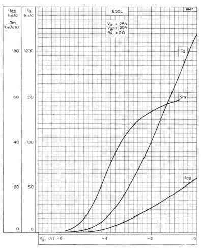
ANODE AND SCREEN-GRID CURRENT AND MUTUAL CONDUCTANCE PLOTTED AGAINST CONTROL-GRID VOLTAGE.  $V_{\rm g2}=125 \text{V}$
