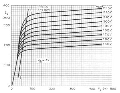
ANODE CURRENT PLOTTED AGAINST ANODE VOLTAGE
