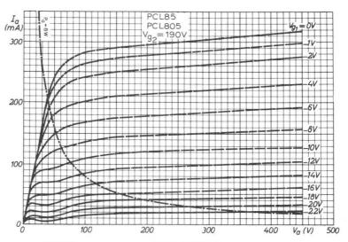
ANODE CURRENT PLOTTED AGAINST ANODE VOLTAGE
