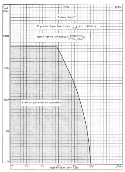
OUTPUT CURRENT PLOTTED AGAINST RECTIFICATION EFFICIENCY
