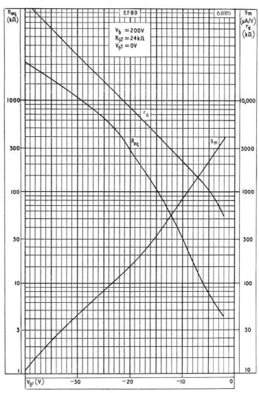
MUTUAL CONDUCTANCE, ANODE IMPEDANCE AND EQUIVALENT NOISE RESISTANCE PLOTTED AGAINST CONTROL-GRID VOLTAGE.  $V_{\rm b}=200 V.$
