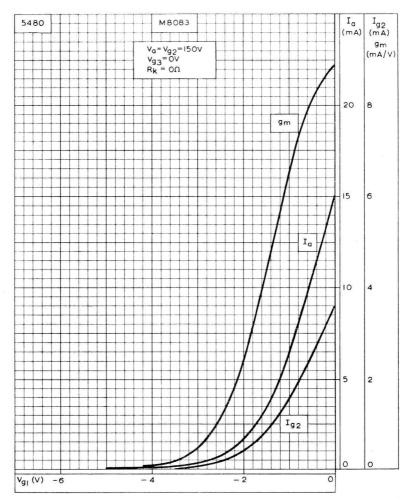
ANODE CURRENT, SCREEN-GRID CURRENT AND MUTUAL CONDUCTANCE PLOTTED AGAINST CONTROL-GRID VOLTAGE.  $V_{\rm a}=V_{\rm g2}=150V$
