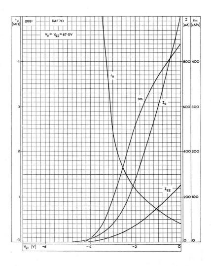
ELECTRODE CURRENTS, MUTUAL CONDUCTANCE AND ANODE IMPEDANCE PLOTTED AGAINST CONTROL-GRID VOLTAGE
