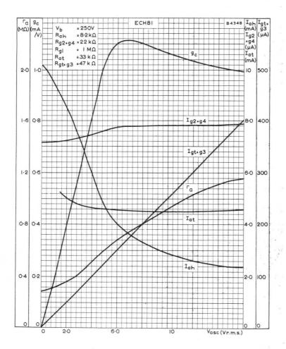
ANODE, SCREEN AND OSCILLATOR GRID CURRENTS, CONVERSION
