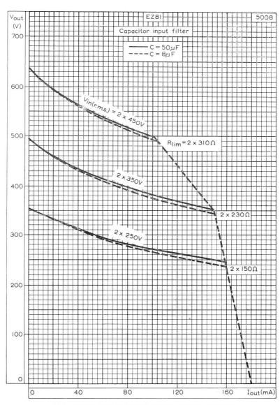
CAPACITOR INPUT FILTER REGULATION CURVES
