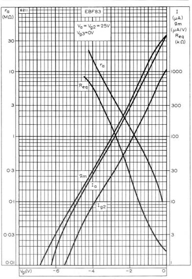
ANODE AND SCREEN-GRID CURRENTS, MUTUAL CONDUCTANCE, ANODE IMPEDANCE AND EQUIVALENT NOISE RESISTANCE PLOTTED AGAINST CONTROL-GRID VOLTAGE.  $V_{\rm a}=V_{\rm g2}=25{\rm V}$
