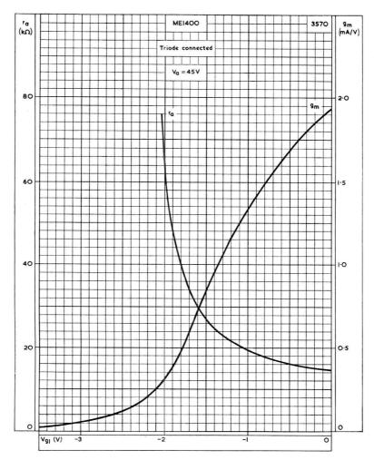
ANODE IMPEDANCE AND MUTUAL CONDUCTANCE PLOTTED AGAINST CONTROL-GRID VOLTAGE. TRIODE CONNECTED.  $V_{\rm a}=45 \text{V}$
