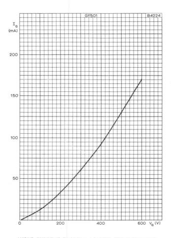
ANODE CURRENT PLOTTED AGAINST ANODE VOLTAGE
