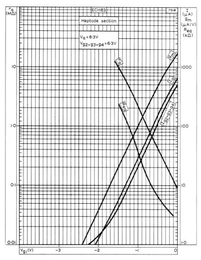
ANODE AND SCREEN-GRID CURRENTS, MUTUAL CONDUCTANCE, ANODE IMPEDANCE AND EQUIVALENT NOISE RESISTANCE PLOTTED AGAINST CONTROL-GRID VOLTAGE FOR HEPTODE SECTION  $V_a = V_{\rm g2+g3+g4} = 6.3 \text{V}$
