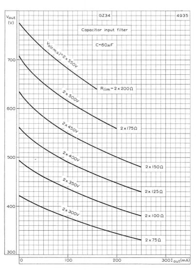
CAPACITOR INPUT FILTER REGULATION CURVES
