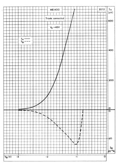
ANODE AND CONTROL-GRID CURRENTS PLOTTED AGAINST CONTROL-GRID VOLTAGE. TRIODE CONNECTED. V $_{\rm a}=$  45V
