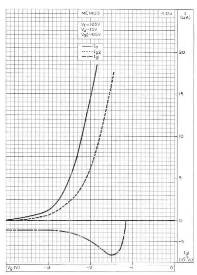
ANODE, SCREEN-GRID AND CONTROL-GRID CURRENTS PLOTTED AGAINST CONTROL-GRID VOLTAGE.  $V_{\rm a}=$  10V,  $V_{\rm g2}=$  6.5V
