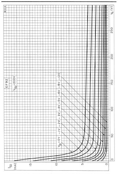
SCREEN-GRID CURRENT PLOTTED AGAINST ANODE VOLTAGE WITH CONTROL-GRID VOLTAGE AS PARAMETER.  $V_{\rm g2} = 200 \text{V}$
