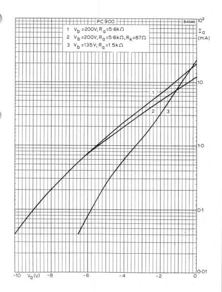
ANODE CURRENT PLOTTED AGAINST GRID VOLTAGE
