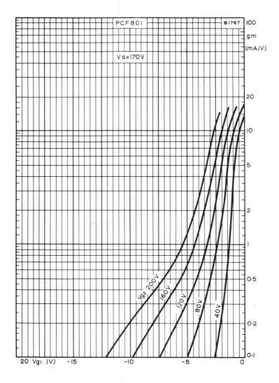
MUTUAL CONDUCTANCE PLOTTED AGAINST CONTROL-GRID VOLTAGE WITH SCREEN-GRID AS PARAMETER,  $\mathbf{V}a = 170V$ .
