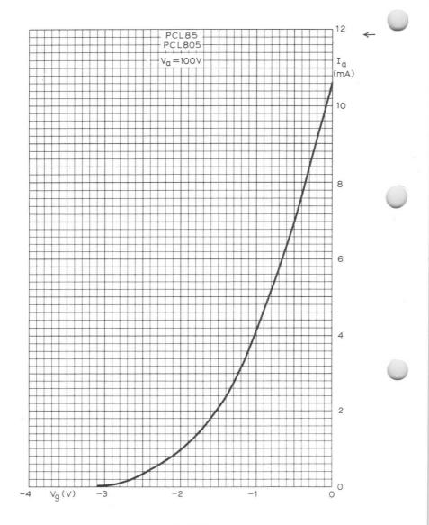
ANODE CURRENT PLOTTED AGAINST CONTROL GRID VOLTAGE: TRIODE SECTION
