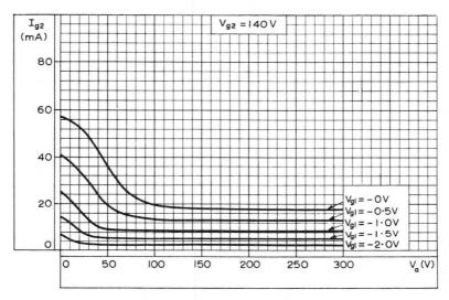
SCREEN-GRID CURRENT PLOTTED AGAINST ANODE VOLTAGE WITH CONTROL-GRID VOLTAGE AS PARAMETER
