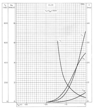
ANODE AND SCREEN-GRID CURRENTS, MUTUAL CONDUCTANCE AND ANODE IMPEDANCE PLOTTED AGAINST CONTROL-GRID VOLTAGE.  $V_a=V_{\rm g2}=150 V$
