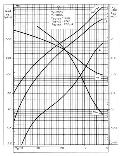
ANODE AND SCREEN-GRID CURRENTS, CONVERSION CONDUCTANCE, ANODE IMPEDANCE AND EQUIVALENT NOISE RESISTANCE PLOTTED AGAINST CONTROL-GRID VOLTAGE WHEN USED AS A FREQUENCY CHANGER.  $V_{\rm a}=200{\rm V}$
