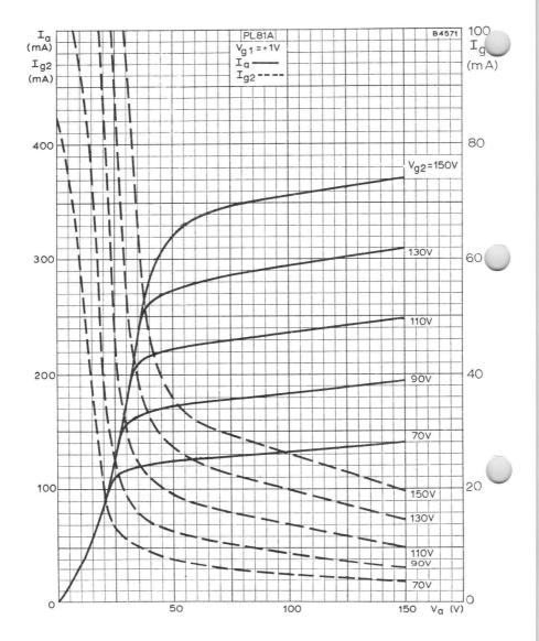
ANODE AND SCREEN CURRENTS PLOTTED AGAINST ANODE VOLTAGE WITH SCREEN-GRID VOLTAGE AS PARAMETER
