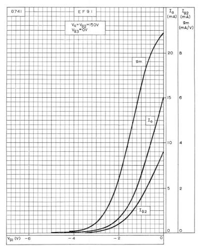
ANODE CURRENT, SCREEN-GRID CURRENT AND MUTUAL CONDUCTANCE PLOTTED AGAINST CONTROL-GRID VOLTAGE.  $V_{\rm a}=V_{\rm g2}=150 \text{V}$
