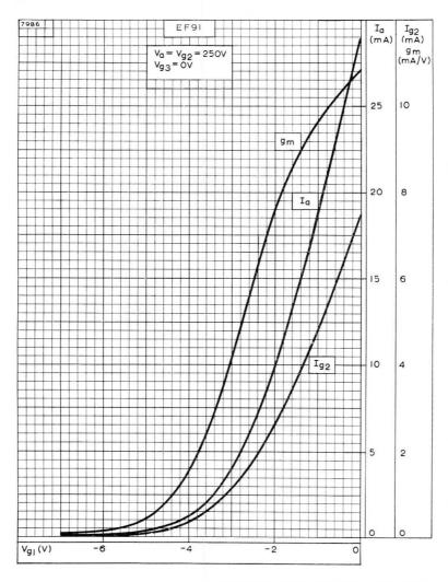
ANODE CURRENT, SCREEN-GRID CURRENT AND MUTUAL CONDUCTANCE PLOTTED AGAINST CONTROL-GRID VOLTAGE.  $V_{\rm a}=V_{\rm g2}=250V$
