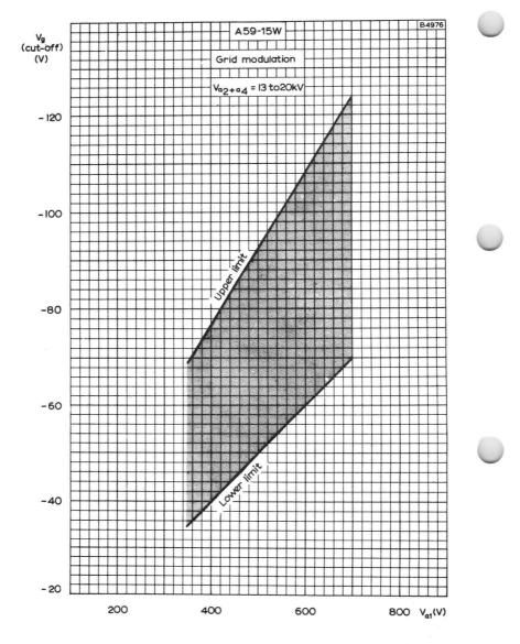
LIMITS OF GRID CUT-OFF VOLTAGE PLOTTED AGAINST FIRST ANODE VOLTAGE. GRID MODULATION.
