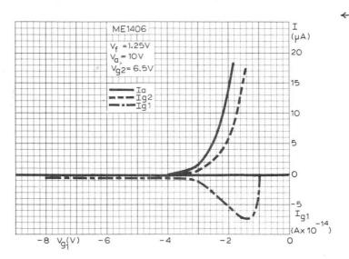
ANODE, SCREEN-GRID AND CONTROL-GRID CURRENTS PLOTTED AGAINST CONTROL-GRID VOLTAGE. V  $_{\rm g}\!=\!6.5{\rm V}$
