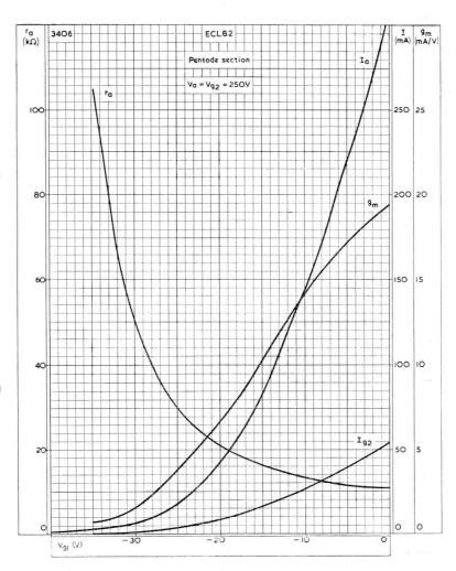
ANODE AND SCREEN-GRID CURRENTS, MUTUAL CONDUCTANCE AND ANODE IMPEDANCE PLOTTED AGAINST CONTROL-GRID VOLTAGE.  $V_a=V_{g_2}=250 \text{V}$
