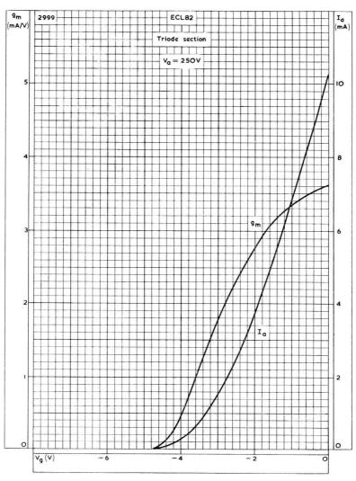
ANODE CURRENT AND MUTUAL CONDUCTANCE PLOTTED AGAINST GRID VOLTAGE FOR TRIODE SECTION.  $V_a := 250 \text{V}$
