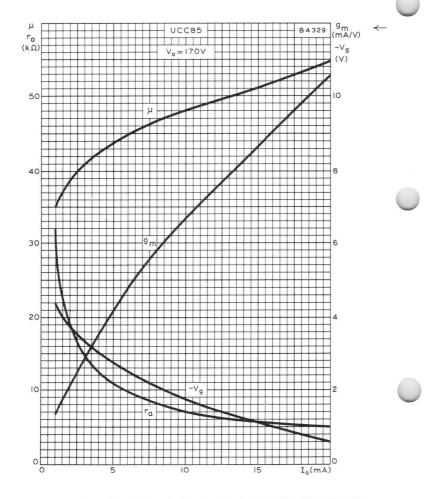
MUTUAL CONDUCTANCE, ANODE IMPEDANCE, AMPLIFICATION FACTOR AND GRID VOLTAGE PLOTTED AGAINST ANODE CURRENT,  $\rm V_a$  = 170V
