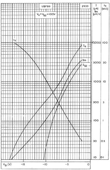
ANODE AND SCREEN-GRID CURRENT, MUTUAL CONDUCTANCE AND ANODE IMPEDANCE PLOTTED AGAINST CONTROL-GRID VOLTAGE  $V_{\rm a}=V_{\rm g_2}=100 V$
