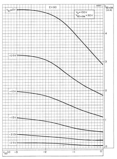
SCREEN-GRID CURRENT PLOTTED AGAINST CONTROL-GRID (g<sub>3</sub>) VOLTAGE WITH CONTROL-GRID (g<sub>1</sub>) VOLTAGE AS PARAMETER
