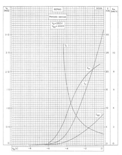
ANODE AND SCREEN-GRID CURRENTS, MUTUAL CONDUCTANCE AND ANODE IMPEDANCE PLOTTED AGAINST CONTROL-GRID VOLTAGE OF PENTODE SECTION.  $V_8\!=\!250V,\ V_{g_2}\!=\!200V$
