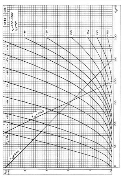
SCREEN-GRID CURRENT PLOTTED AGAINST SCREEN-GRID VOLTAGE
