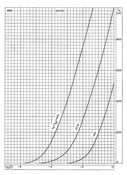
ANODE CURRENT PLOTTED AGAINST CONTROL-GRID VOLTAGE
