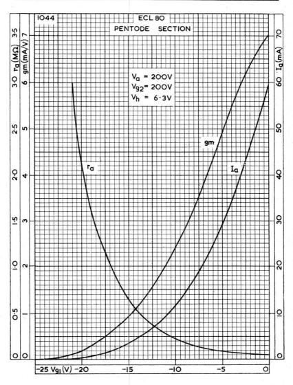
ANODE CURRENT, MUTUAL CONDUCTANCE AND INTERNAL RESISTANCE OF PENTODE SECTION PLOTTED AGAINST CONTROL-GRID VOLTAGE, FOR SCREEN-GRID VOLTAGE OF 200V
