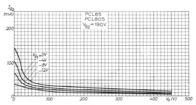
SCREEN GRID CURRENT PLOTTED AGAINST ANODE VOLTAGE
