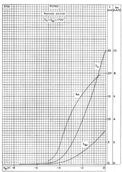
ANODE AND SCREEN-GRID CURRENTS AND MUTUAL CONDUCTANCE PLOTTED AGAINST CONTROL-GRID VOLTAGE OF PENTODE SECTION.  $V_a=V_{\rm g_2}=170 V$
