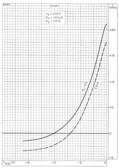
LENGTH OF COLUMN PLOTTED AGAINST CONTROL-GRID VOLTAGE
