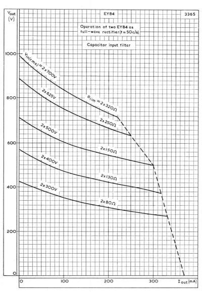
CAPACITOR INPUT FILTER REGULATION CURVES
