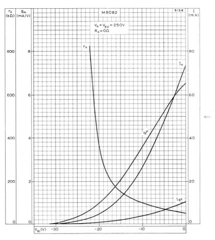
ANODE AND SCREEN-GRID CURRENTS, MUTUAL CONDUCTANCE AND ANODE IMPEDANCE PLOTTED AGAINST CONTROL-GRID VOLTAGE,  $V_a=V_{\rm g2}=250 \text{V}$
