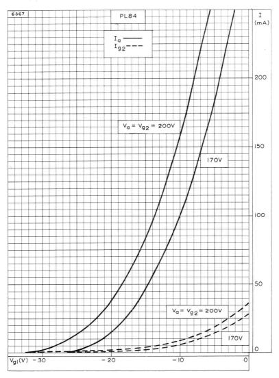
ANODE AND SCREEN-GRID CURRENTS PLOTTED AGAINST CONTROL-GRID VOLTAGE FOR VARIOUS ANODE AND SCREEN-GRID VOLTAGES
