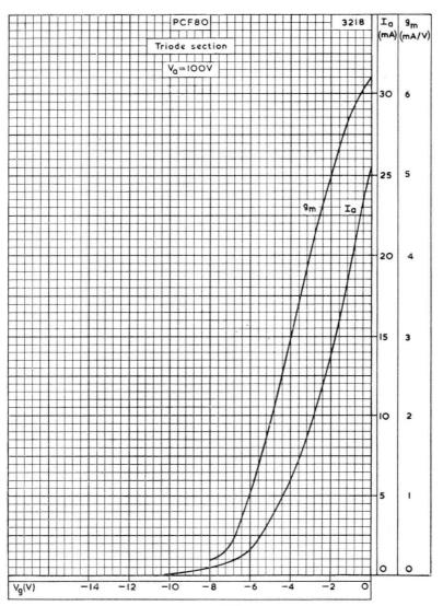
ANODE CURRENT AND MUTUAL CONDUCTANCE PLOTTED AGAINST GRID VOLTAGE FOR TRIODE SECTION.  $V_{\rm a}=100\text{V}$
