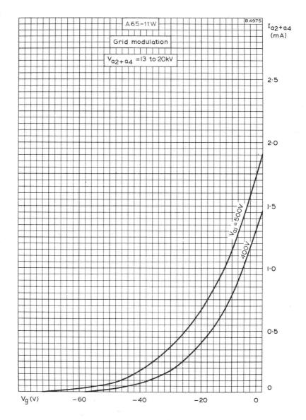
FINAL ANODE CURRENT PLOTTED AGAINST GRID VOLTAGE.
