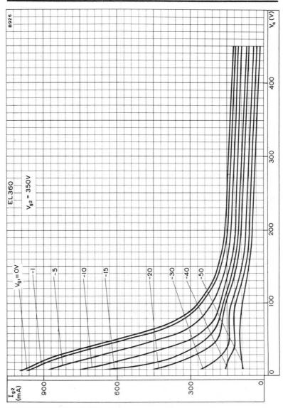
SCREEN-GRID CURRENT PLOTTED AGAINST ANODE VOLTAGE WITH CONTROL-GRID VOLTAGE AS PARAMETER.  $V_{\rm g2}=350 V$
