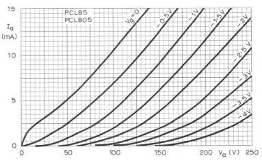
ANODE CURRENT PLOTTED AGAINST ANODE VOLTAGE
