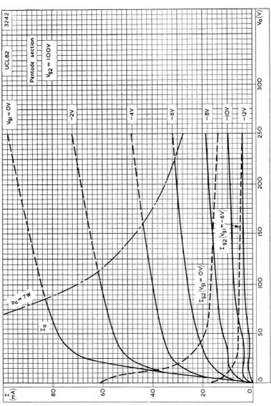
ANODE CURRENT PLOTTED AGAINST ANODE VOLTAGE WITH CONTROL-GRID VOLTAGE AS PARAMETER.  $V_{\rm g_2}{=}100 \text{V}$
