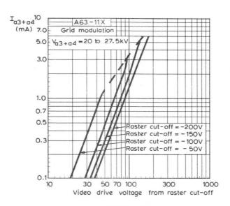
FINAL ANODE CURRENT PLOTTED AGAINST GRID VOLTAGE. GRID MODULATION
