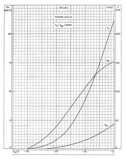
ANODE AND SCREEN-GRID CURRENTS AND MUTUAL CONDUCTANCE PLOTTED AGAINST CONTROL-GRID VOLTAGE.  $V_{\rm a}=V_{\rm g_2}=200 \text{V}$
