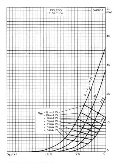
ANODE CURRENT PLOTTED AGAINST CONTROL-GRID VOLTAGE WITH ANODE AND SCREEN-GRID VOLTAGES AS PARAMETERS AND WITH MUTUAL CONDUCTANCE CONTOURS.
