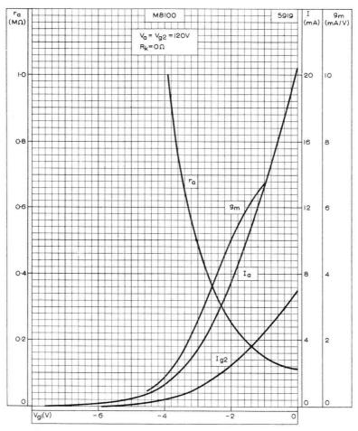
ANODE CURRENT, SCREEN-GRID CURRENT, MUTUAL CONDUCTANCE AND ANODE IMPEDANCE PLOTTED AGAINST CONTROL-GRID VOLTAGE.  $V_{a}=120\text{V}$
