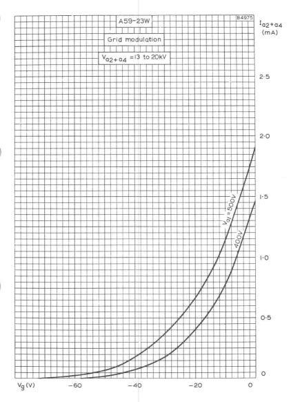
FINAL ANODE CURRENT PLOTTED AGAINST GRID VOLTAGE.
