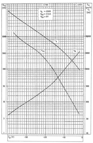
MUTUAL CONDUCTANCE, ANODE IMPEDANCE AND EQUIVALENT NOISE RESISTANCE PLOTTED AGAINST CONTROL-GRID VOLTAGE.  $V_{\rm b}=250 \rm V.$
