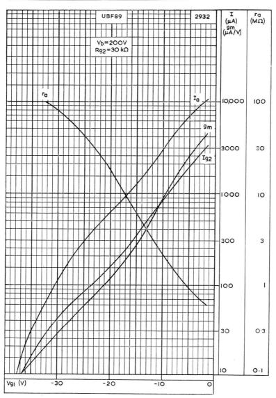
ANODE AND SCREEN-GRID CURRENT, MUTUAL CONDUCTANCE AND ANODE IMPEDANCE PLOTTED AGAINST CONTROL-GRID VOLTAGE  $\rm V_b = 200V$
