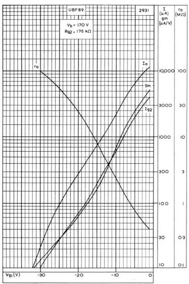
ANODE AND SCREEN-GRID CURRENT, MUTUAL CONDUCTANCE AND ANODE IMPEDANCE PLOTTED AGAINST CONTROL-GRID VOLTAGE  $V_{\rm h}=170{\rm V}$
