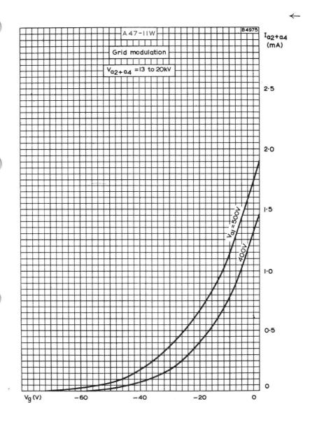
FINAL ANODE CURRENT PLOTTED AGAINST GRID VOLTAGE.
