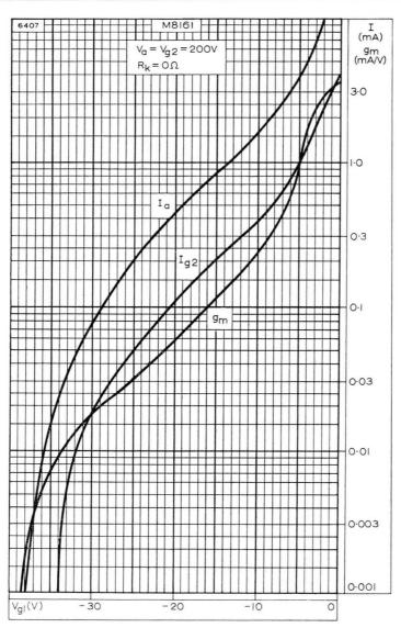
ANODE CURRENT, SCREEN-GRID CURRENT AND MUTUAL CONDUCTANCE PLOTTED AGAINST CONTROL-GRID VOLTAGE.  $V_{\rm a}=V_{\rm g2}=200V.$
