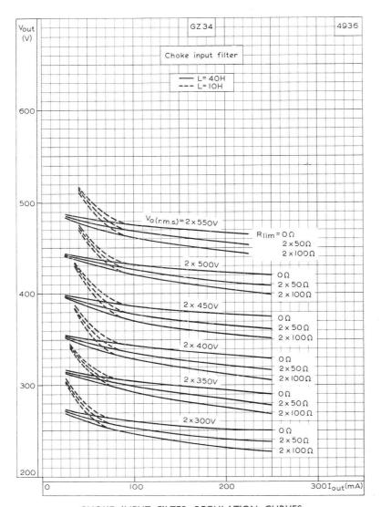
CHOKE INPUT FILTER REGULATION CURVES
