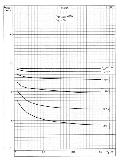
SCREEN-GRID CURRENT PLOTTED AGAINST ANODE VOLTAGE WITH CONTROL-GRID (ga) VOLTAGE AS PARAMETER
