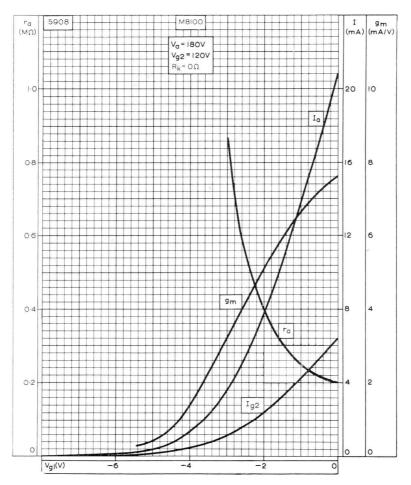
ANODE CURRENT, SCREEN-GRID CURRENT, MUTUAL CONDUCTANCE AND ANODE IMPEDANCE PLOTTED AGAINST CONTROL-GRID VOLTAGE.  $V_{\rm a}=180 V$
