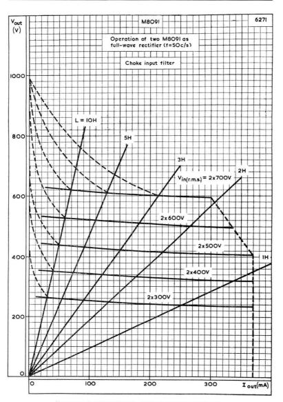
CHOKE INPUT FILTER REGULATION CURVES
