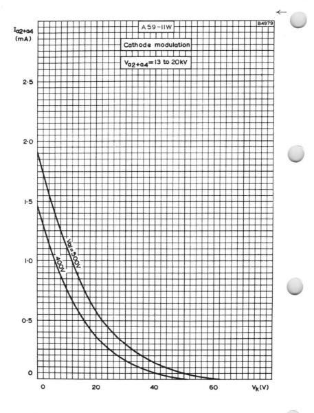
FINAL ANODE CURRENT PLOTTED AGAINST CATHODE-TO-GRID VOLTAGE, CATHODE MODULATION.
