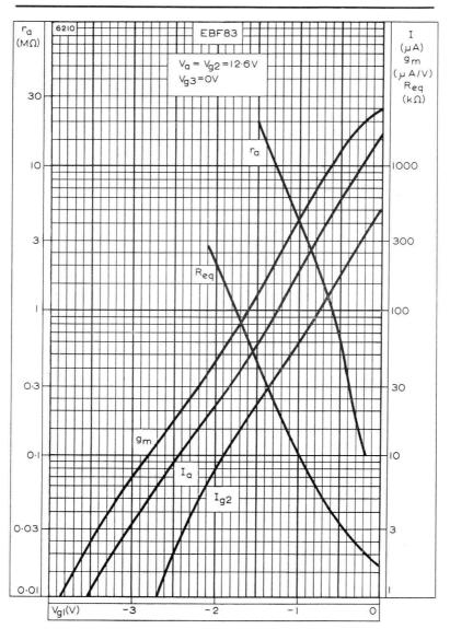
ANODE AND SCREEN-GRID CURRENTS, MUTUAL CONDUCTANCE, ANODE IMPEDANCE AND EQUIVALENT NOISE RESISTANCE PLOTTED AGAINST CONTROL-GRID VOLTAGE.  $V_{\rm a}=V_{\rm g2}=12.6V$
