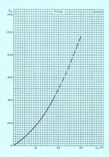
ANODE CURRENT PLOTTED AGAINST ANODE VOLTAGE
