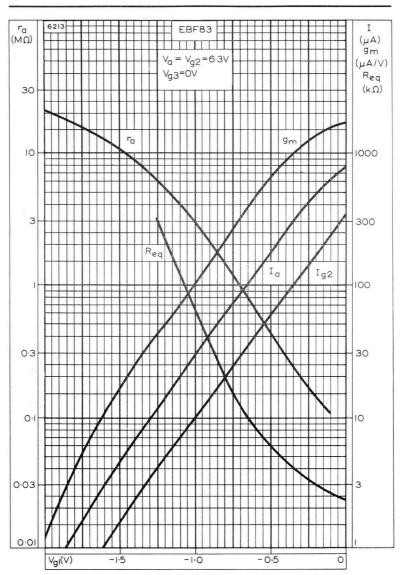
ANODE AND SCREEN-GRID CURRENTS, MUTUAL CONDUCTANCE, ANODE IMPEDANCE AND EQUIVALENT NOISE RESISTANCE PLOTTED AGAINST CONTROL-GRID VOLTAGE.  $V_{\rm a}=V_{\rm g2}=6.3{\rm V}$
