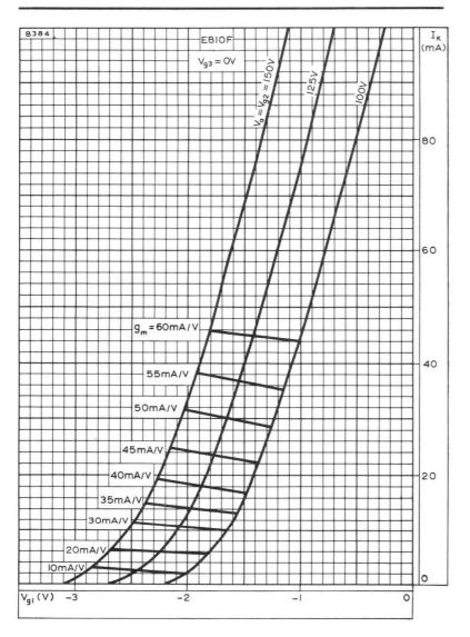
CATHODE CURRENT PLOTTED AGAINST CONTROL-GRID VOLTAGE WITH ANODE VOLTAGE AS PARAMETER AND WITH MUTUAL CONDUCTANCE CONTOURS
