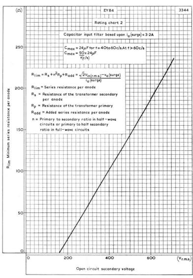
MINIMUM SERIES ANODE RESISTANCE PLOTTED AGAINST OPEN CIRCUIT
