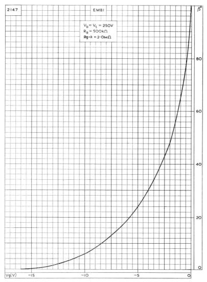
LIGHT ANGLE PLOTTED AGAINST CONTROL-GRID VOLTAGE
