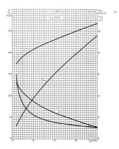
MUTUAL CONDUCTANCE, ANODE IMPEDANCE, AMPLIFICATION FACTOR AND GRID VOLTAGE PLOTTED AGAINST ANODE CURRENT,  $\mathbf{V_a} = 200 \mathrm{V}$
