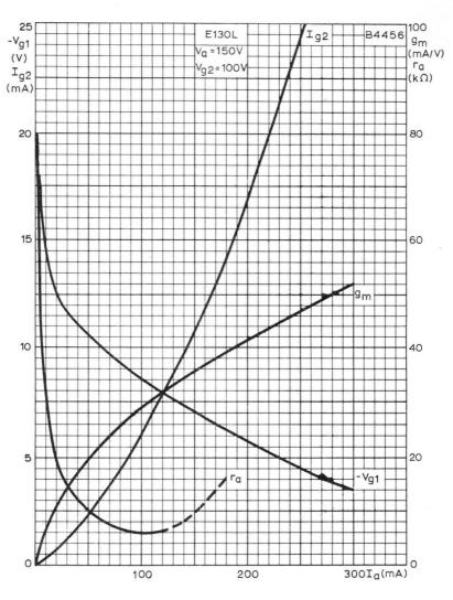
SCREEN CURRENT, CONTROL-GRID VOLTAGE, MUTUAL CONDUCTANCE AND ANODE IMPEDANCE PLOTTED AGAINST ANODE CURRENT  $V_a^{}{=}150V,\;V_{g2}^{}{=}100V$
