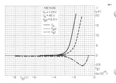
ANODE, SCREEN-GRID AND CONTROL-GRID CURRENTS PLOTTED AGAINST CONTROL-GRID VOLTAGE. V  $_{\rm g}\!=\!45\rm{V},~V_{\rm g2}\!=\!6.5\rm{V}$
