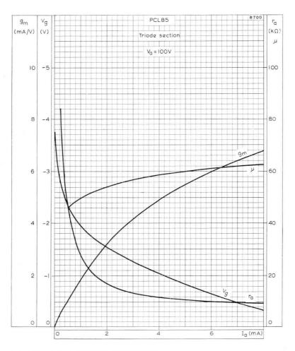
GRID VOLTAGE, MUTUAL CONDUCTANCE, ANODE IMPEDANCE AND AMPLIFICATION FACTOR PLOTTED AGAINST ANODE CURRENT.
