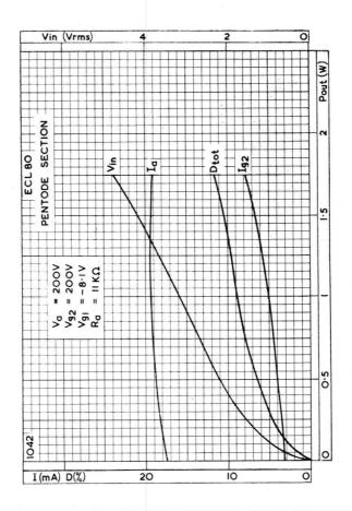
ANODE CURRENT, SCREEN-GRID CURRENT, INPUT VOLTAGE AND TOTAL DISTORTION PLOTTED AGAINST POWER OUTPUT, FOR SCREEN-GRID VOLTAGE OF 200V
