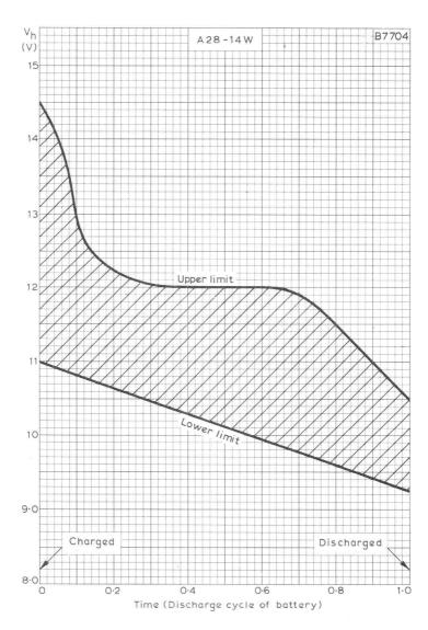
HEATER VOLTAGE PLOTTED AGAINST BATTERY DISCHARGE CYCLE
