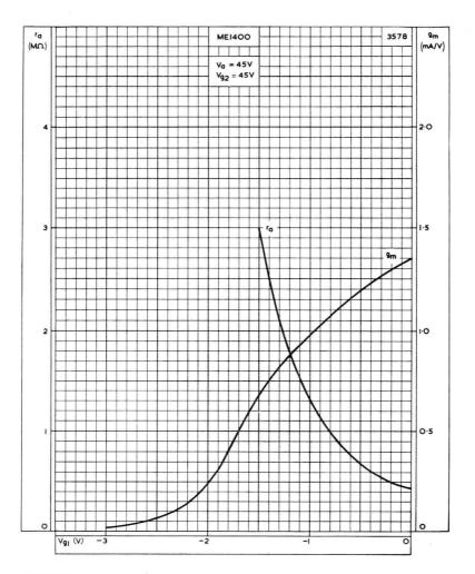
ANODE IMPEDANCE AND MUTUAL CONDUCTANCE PLOTTED AGAINST CONTROL-GRID VOLTAGE.  $V_{\rm a}=V_{\rm g2}=45 \text{V}$
