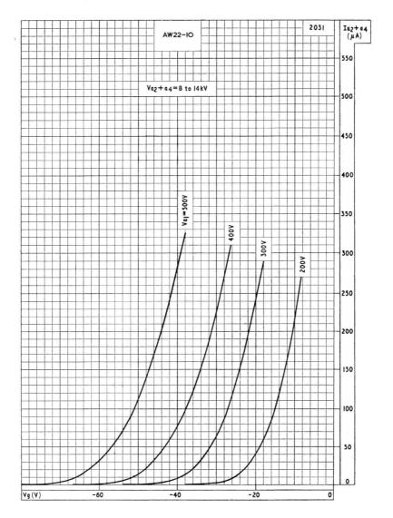
FINAL ANODE CURRENT PLOTTED AGAINST GRID VOLTAGE
