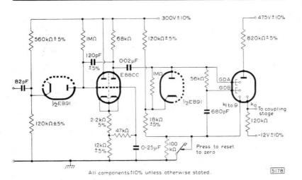
FIG. 1. INTEGRATED PULSE DRIVE CIRCUIT
