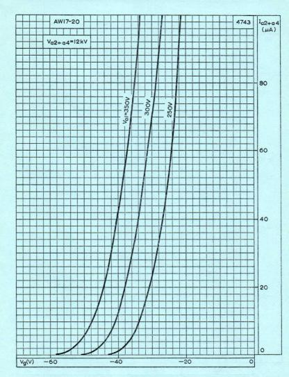
FINAL ANODE CURRENT PLOTTED AGAINST GRID VOLTAGE
