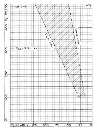
LIMITS OF GRID CUT-OFF VOLTAGE PLOTTED AGAINST FIRST ANODE VOLTAGE
