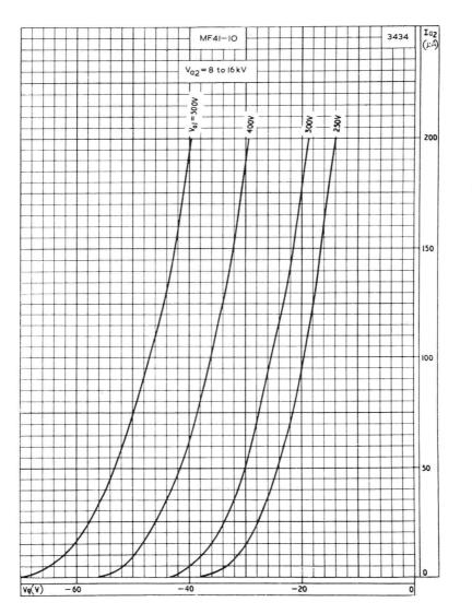
FINAL ANODE CURRENT PLOTTED AGAINST GRID VOLTAGE
