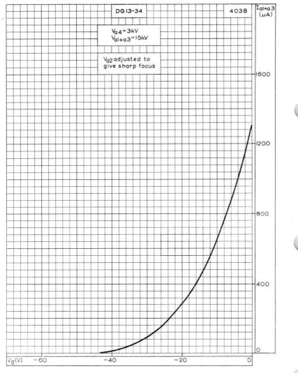
FINAL ANODE CURRENT PLOTTED AGAINST GRID VOLTAGE
