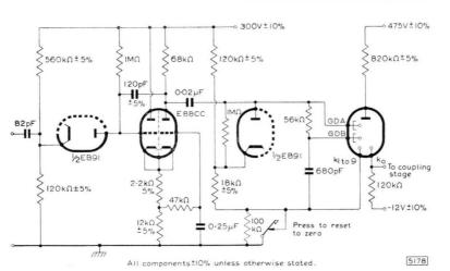
FIG. 1. INTEGRATED PULSE DRIVE CIRCUIT
