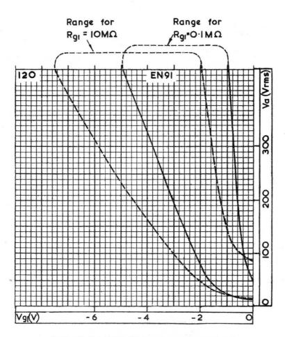
OPERATING RANGE OF CRITICAL GRID VOLTAGE
