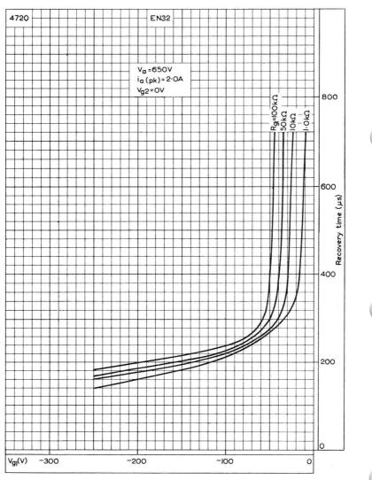
RECOVERY TIME PLOTTED AGAINST CONTROL-GRID VOLTAGE
