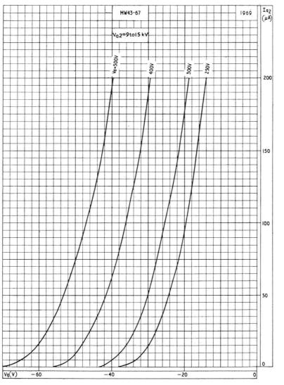
FINAL ANODE CURRENT PLOTTED AGAINST GRID VOLTAGE
