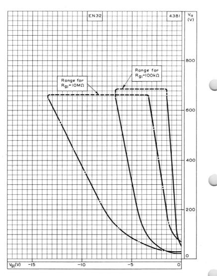
OPERATING RANGE OF CRITICAL GRID VOLTAGE
