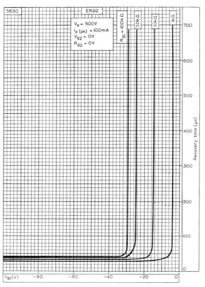
RECOVERY TIME PLOTTED AGAINST CONTROL-GRID VOLTAGE
