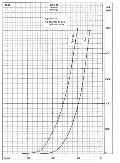
FINAL ANODE CURRENT PLOTTED AGAINST GRID VOLTAGE
