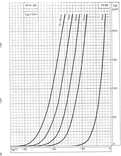
FINAL ANODE CURRENT PLOTTED AGAINST GRID VOLTAGE
