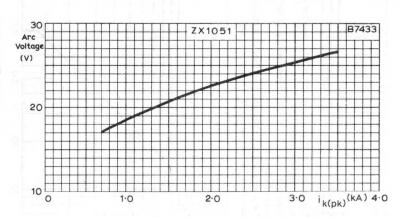
TYPICAL ARC VOLTAGE PLOTTED AGAINST CATHODE CURRENT
