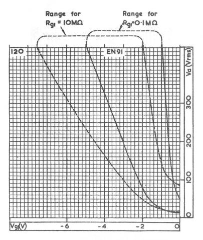
OPERATING RANGE OF CRITICAL GRID VOLTAGE
