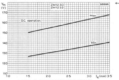
ANODE-TO-CATHODE MAINTAINING VOLTAGE PLOTTED AGAINST CATHODE CURRENT
