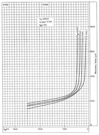
RECOVERY TIME PLOTTED AGAINST CONTROL-GRID VOLTAGE
