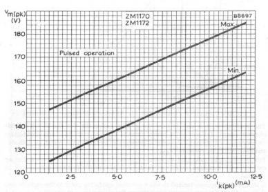
PEAK ANODE-TO-CATHODE MAINTAINING VOLTAGE
