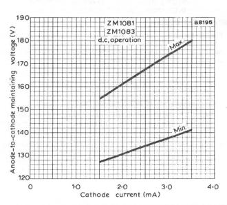
ANODE-TO-CATHODE MAINTAINING VOLTAGE PLOTTED AGAINST CATHODE CURRENT
