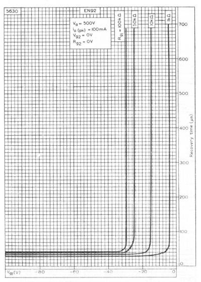
RECOVERY TIME PLOTTED AGAINST CONTROL-GRID VOLTAGE
