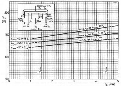
MAINTAINING VOLTAGE PLOTTED AGAINST ANODE CURRENT
