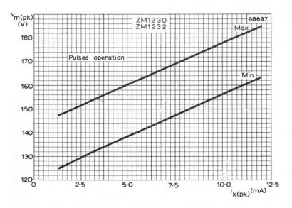
PEAK ANODE-TO-CATHODE MAINTAINING VOLTAGE
