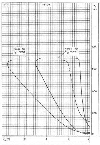
OPERATING RANGE OF CRITICAL CONTROL-GRID VOLTAGE
