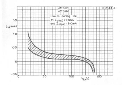
SUM OF THE TOTAL PROBE CURRENT TO ALL NON-ILLUMINATED CATHODES PLOTTED AGAINST CATHODE BIAS VOLTAGE (HALF-WAVE A.C. OPERATION)
