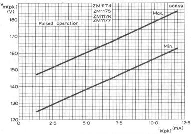
PEAK ANODE-TO-CATHODE MAINTAINING VOLTAGE
