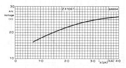
TYPICAL ARC VOLTAGE PLOTTED AGAINST CATHODE CURRENT
