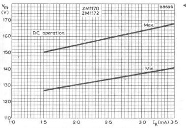
ANODE-TO-CATHODE MAINTAINING VOLTAGE PLOTTED AGAINST CATHODE CURRENT
