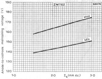
ANODE-TO-CATHODE MAINTAINING VOLTAGE PLOTTED AGAINST CATHODE CURRENT
