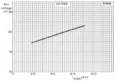
TYPICAL ARC VOLTAGE PLOTTED AGAINST CATHODE CURRENT
