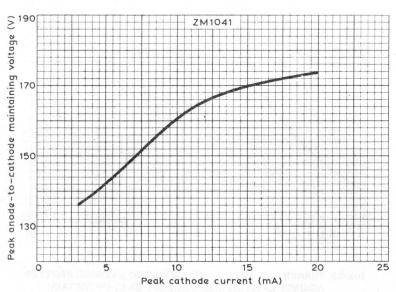
PEAK ANODE-TO-CATHODE MAINTAINING VOLTAGE PLOTTED AGAINST PEAK CATHODE CURRENT
