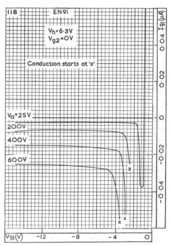
CONTROL-GRID CURRENT PLOTTED AGAINST CONTROL-GRID
