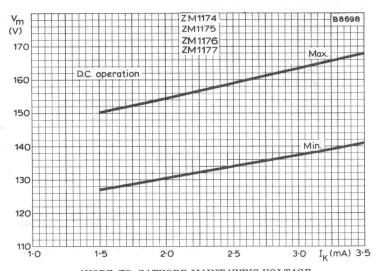
ANODE-TO-CATHODE MAINTAINING VOLTAGE PLOTTED AGAINST CATHODE CURRENT
