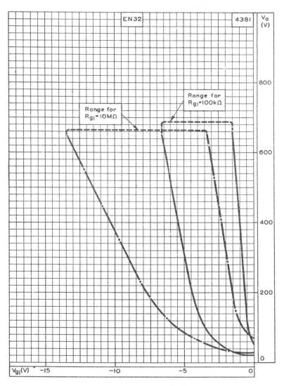
OPERATING RANGE OF CRITICAL GRID VOLTAGE
