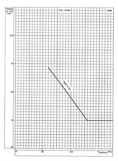
TOTAL HEATING-UP TIME PLOTTED AGAINST AMBIENT TEMPERATURE
