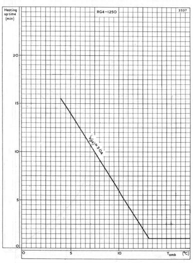
TOTAL HEATING-UP TIME PLOTTED AGAINST AMBIENT TEMPERATURE
