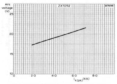
TYPICAL ARC VOLTAGE PLOTTED AGAINST CATHODE CURRENT
