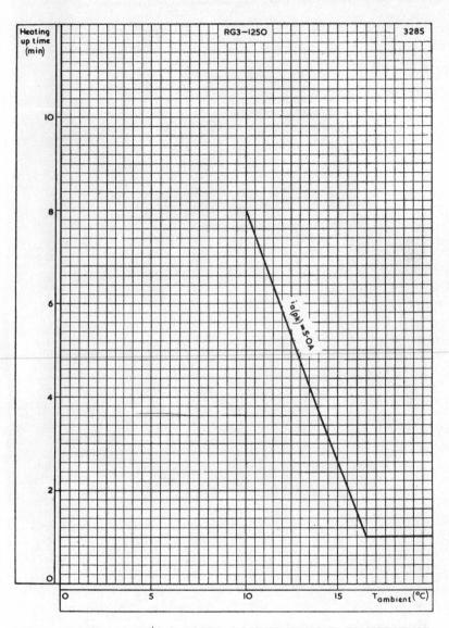
TOTAL HEATING-UP TIME PLOTTED AGAINST AMBIENT TEMPERATURE
