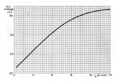
TYPICAL ARC VOLTAGE PLOTTED AGAINST CATHODE CURRENT
