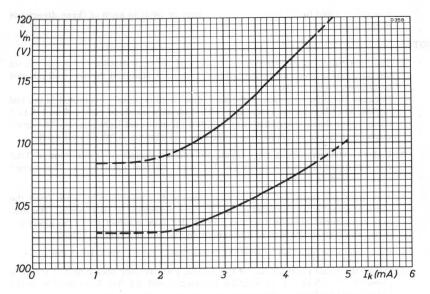
ANODE-TO-CATHODE MAINTAINING VOLTAGE PLOTTED AGAINST CATHODE CURRENT
