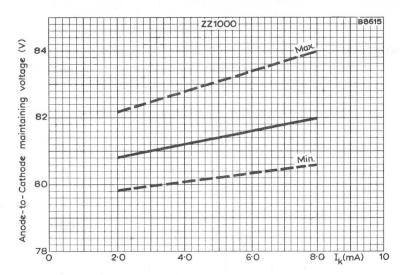
ANODE-TO-CATHODE MAINTAINING VOLTAGE PLOTTED AGAINST CATHODE CURRENT
