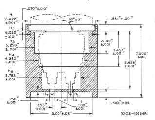
NOTE: THE FIVE CYLINDRICAL HOLES  $\rm H_1$ ,  $\rm H_2$ ,  $\rm H_3$ ,  $\rm H_4$  AND  $\rm H_5$  HAVE AXES COINCIDENT WITHIN 0.001". THE HOLES  $\rm H_6$  AND  $\rm H_7$  HAVE AXES PARALLEL TO THE AXES OF  $\rm H_1$ ,  $\rm H_2$ ,  $\rm H_3$ ,  $\rm H_4$  AND  $\rm H_5$  WITHIN 0°  $\rm \pm 2$ ".
