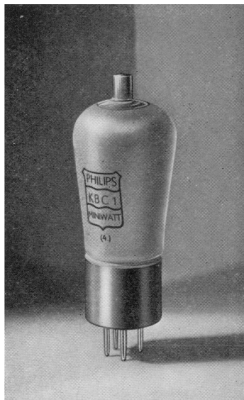
Abb. 1 KBC 1, die neue Detektor- und Niederfrequenzröhre der Batterie-
