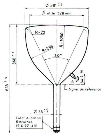
La ligne de référence est déterminée par le plan A-B de la bague S 22 220 lorsqu'elle vient buter sur le raccordement col bulbe.
