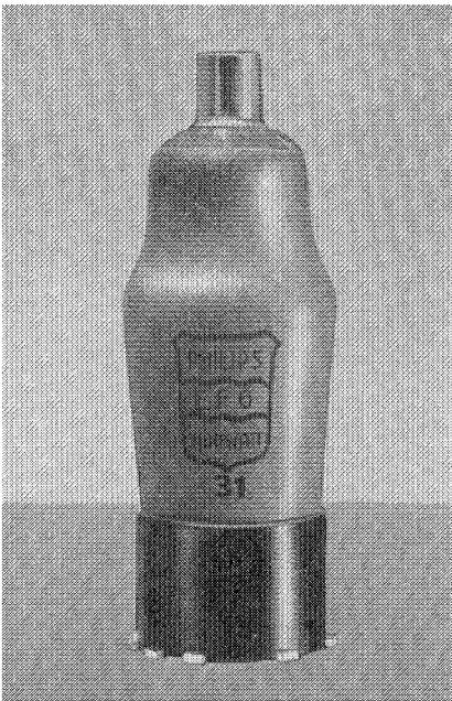
Schematische voorstelling van de h.f. penthode-selectode EF 6, benevens schema van aansluiting der elektroden aan de huls. Het stuurrooster is met de topaansluiting van den ballon verbonden.
